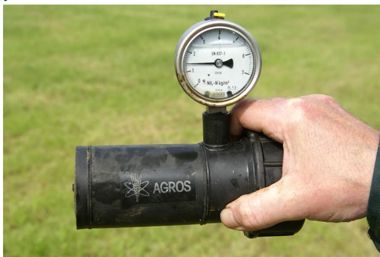
BILLEDE 2. EN AGROS MÅLER ER EN HURTIG OG FORHOLDSVIS SIKKER METODE TIL AT MÅLE GYLLENS INDHOLD AF AMMONIUMKVÆLSTOF. FOTO: TORKILD BIRKMOSE
